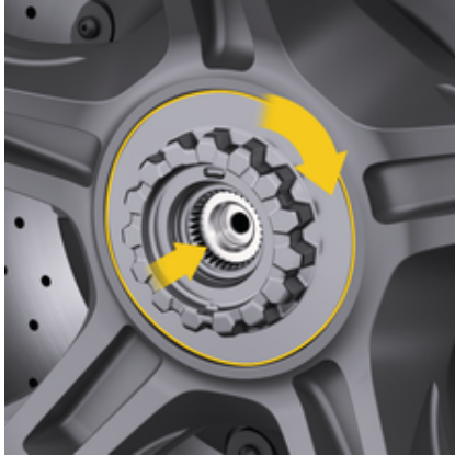
рис. 185: Вкручування центрального болта
