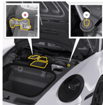
рис. 158: Полюсні клеми свинцево-кислотного акумулятора
