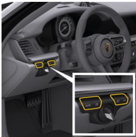
рис. 74: Панель керування освітлювальними приладами
