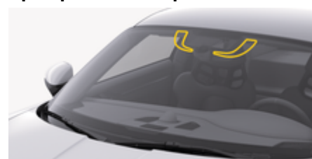
рис. 120: Кріплення пристроїв оплати дорожнього мита
