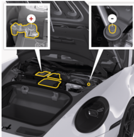
рис. 159: Полюсні клеми свинцево-кислотного акумулятора
