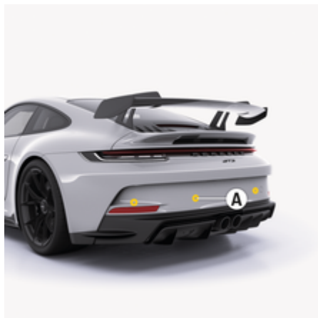
рис. 79: Ультразвукові датчики для вимірювання відстані
