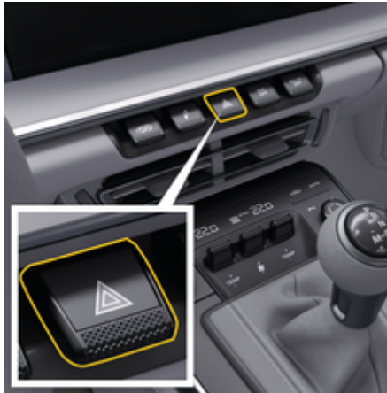
рис. 77: Увімкнення та вимкнення світлової аварійної сигналізації
