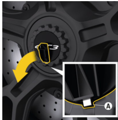
рис. 175: Знімання кришки з використанням допоміжного інструмента
