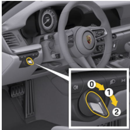
рис. 67: Положення ключа в замку запалювання
